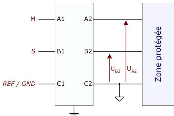
Lors du déclenchement du parafoudre, la tension des lignes M et S augmente au dessus de la tension  $U_C$ . Cette tension est appelée tension résiduelle  $U_R$ .
